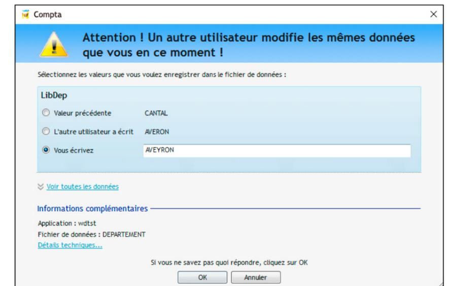
Ici, 2 utilisateurs tentent de modifier en même temps le même champ ! Si le cas n'est pas géré par programmation (blocage de ligne), une fenêtre s'ouvre automatiquement et demande quelle valeur prendre. Il n'y a rien à programmer.
